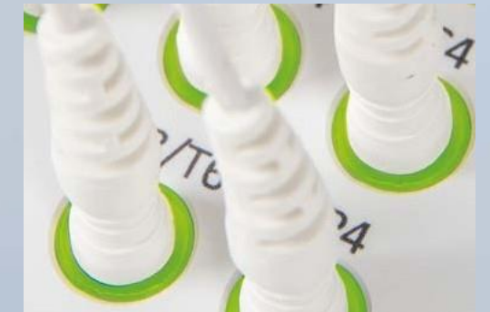
Los indicadores de impedancia codificados por color en las entradas del amplificador para monitorear la matriz de electrodos y reposicionar el electrodo rápidamente.
