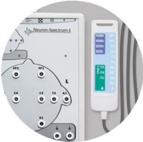
cabezal CFM especialmente diseñado con 2 metros de cable que puede ser fácilmente colocado en el lugar de asistencia del paciente (por ejemplo en la incubadora del infante), asegurando la colocación conveniente y rápida de los electrodos
